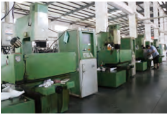
电火花机床 电加工各种异形模具, 加工精度0.005mm
