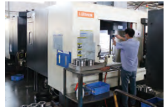
加工中心 加工精度0.005mm, 往复精度0.01mm
