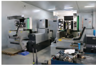
慢走丝线切割机床 加工精度可达0.005mm, 加工R半径0.05mm
