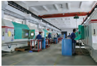
数控平面磨床 加工精度0.003mm
