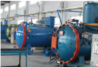
真空热处理炉 针对各种产品选择最优的热处理方案
