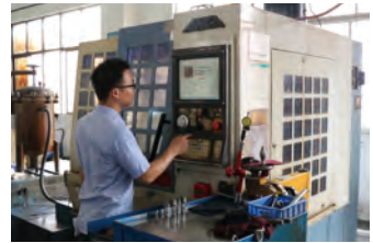
数控曲面磨床 加工各种曲面, 精度0.01mm
